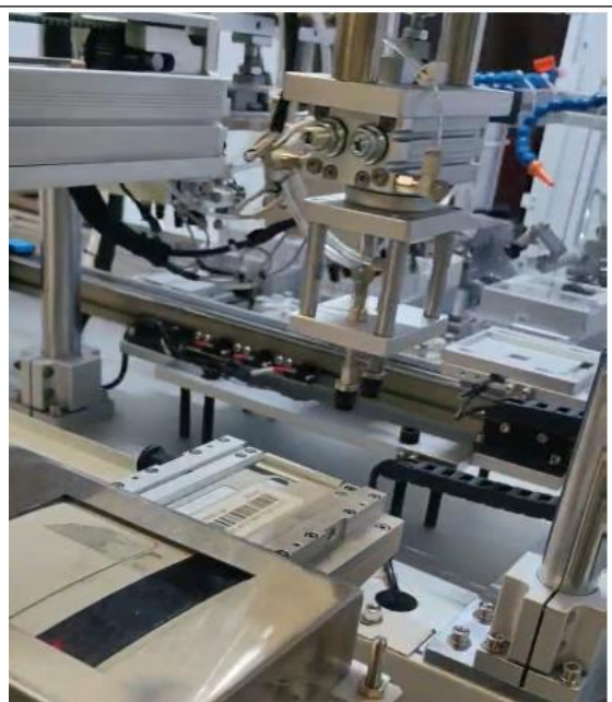
自动安装铭牌
